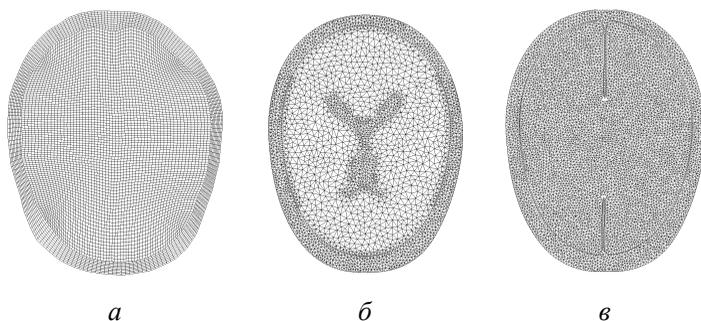
**Рис. 3.** Расчетные сетки: *a* – двухкомпонентная модель, *б* – модель с желудочками, *в* – модель с мембраной
