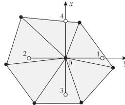
**Рис. 2.** Реконструкция структурированного шаблона на треугольной сетке
