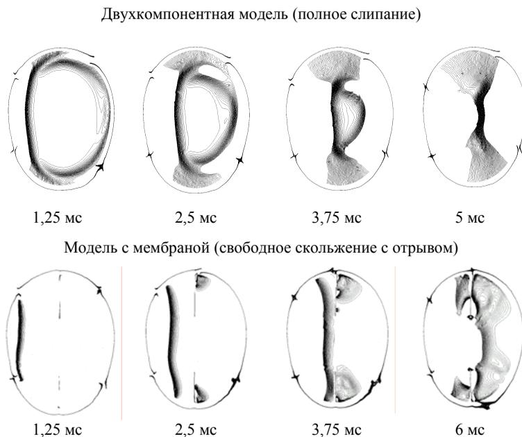
**Рис. 4.** Изолинии давления для различных моментов времени (удар слева)
